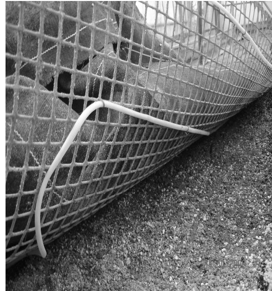
Εικόνα 2. Ηλεκτρικές αντιστάσεις θέρμανσης στην κάτω πλευρά πλαστικού πλέγματος.
