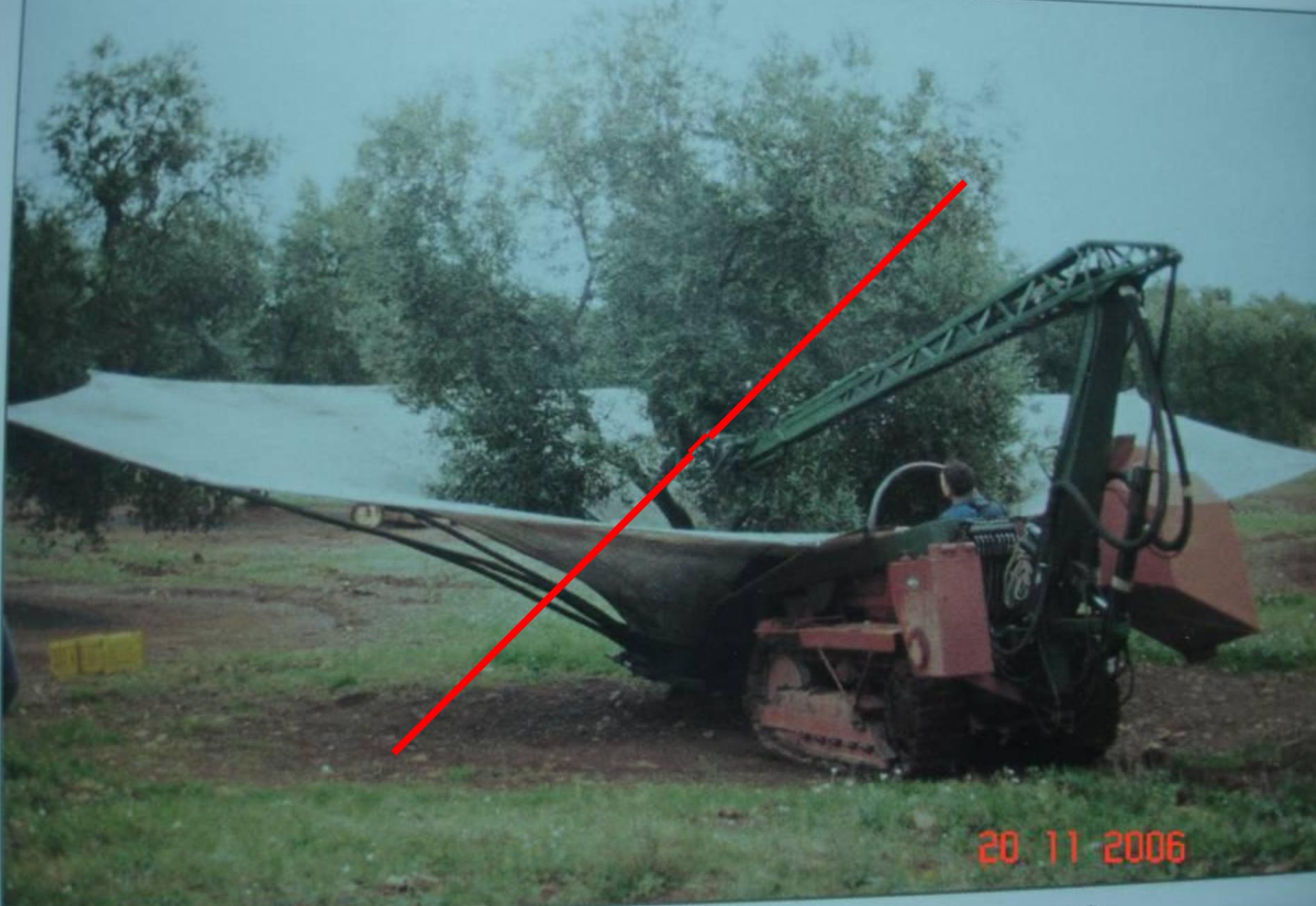
Fig. 14.32. Un dispositivo per estrarre le olive dalla roccia incorporato in uno scuotitore di branche.
