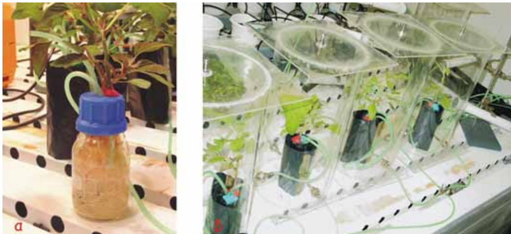
Εικόνα III.1. Διάταξη υδροπονικής καλλιέργειας. α. φυτό το οποίο αναπτύσσονται σε ατμόσφαιρα κανονικής συγκέντρωσης \text{CO}_2 . β. φυτά που αναπτύσσονται σε αεροστεγείς θαλάμους ελεγχόμενης ατμόσφαιρας \text{CO}_2 .
