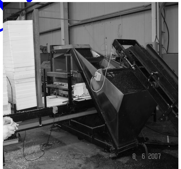
Εικόνα 16. Πνευματική μηχανή σποράς σε ατομικές θέσεις σε φελιζόλ (φυτώριο λαχανικομικών).
